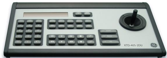
Le KTD-405-2DU peut être configuré pour fonctionner en trois modes : zone discrète, zone transparente et Digiplex standard. En modes de zone discrète et transparente, le système peut être divisé en 32 zones avec un maximum de 64 caméras dans chaque zone. Les multiplexeurs et les sélecteurs de matrice peuvent être utilisés dans ces modes. En mode Digiplex standard, un sélecteur de matrice représente l'appareil de connexion principal du système.
